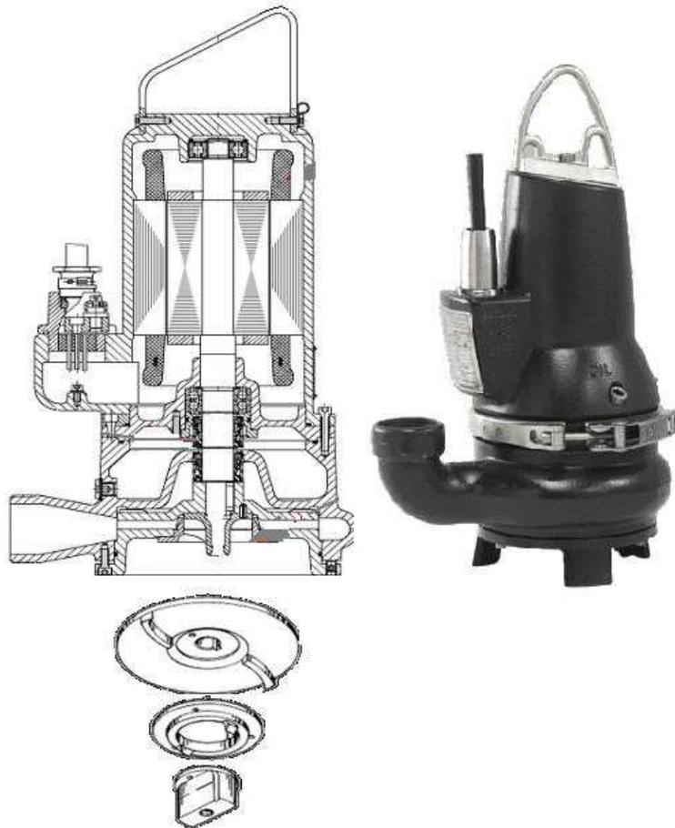
Gbr. 3.2.1.5 Pompa air kotor dengan cutter impeller
