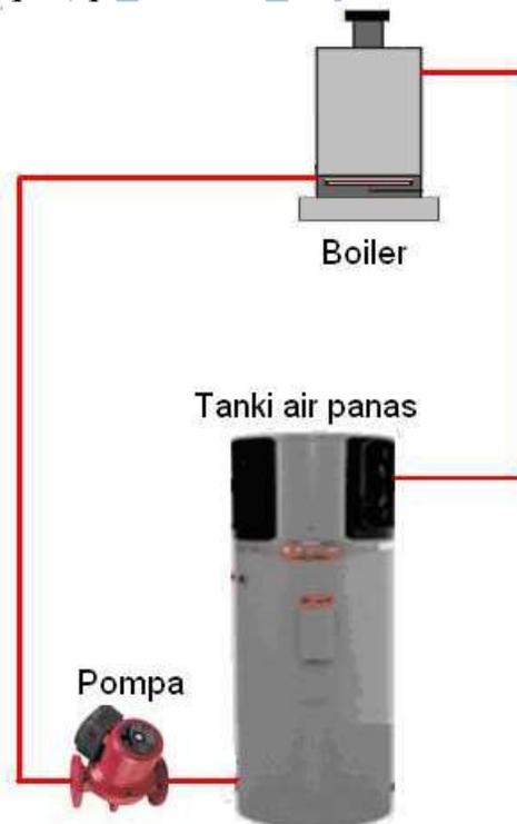
Gbr.2.3.1.1. Pompa sirkulator dari tangki penyimpanan ke heater/boiler.
